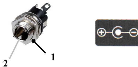
Рис. 3. Разъем DC IN (гнездо) 1 – плюс питания (корпус разъёма), 2 – минус питания (центральный штырь)
